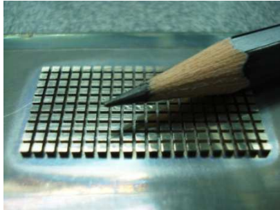
รูปที่ 2 แม่พิมพ์โลหะบนฐานสแตนเลส ห้องเพาะเลี้ยงสำหรับยบนจำนวน 200 ห้องบนแผ่นกระจก
