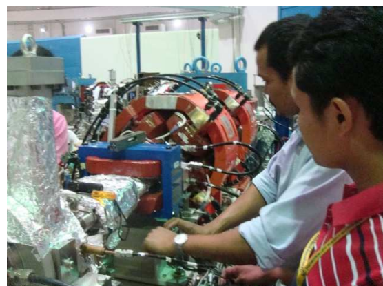
รูปที่ 17 การ Alignment แม่เหล็กสำหรับปรับตำแหน่ง (Steering Magnet)
