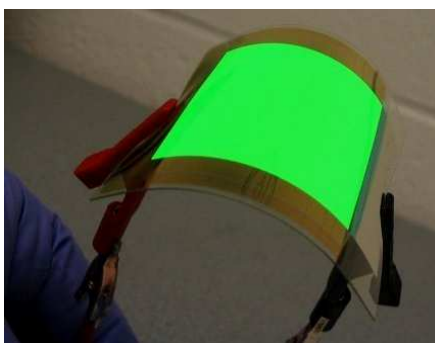
รูปที่1 ตัวอย่างไดโอดเปล่งแสงที่ทำมาจากพลาสติกและจอภาพที่ทำมาจากสารกึ่งตัวนำพลาสติก
