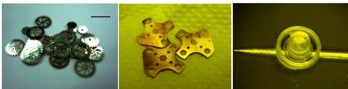
รูปที่ 14 ชิ้นส่วนจุลภาคที่ถูกรังสีเป็นโลหะและโครงสร้างร่วมพอลิเมอร์-โลหะ
