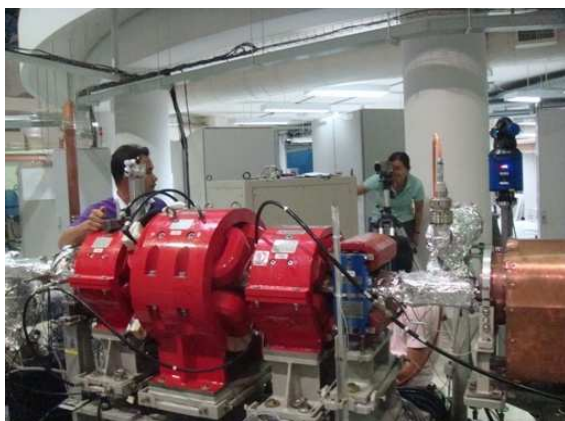
รูปที่ 16 การ Alignment แม่เหล็กหกขั้ว
