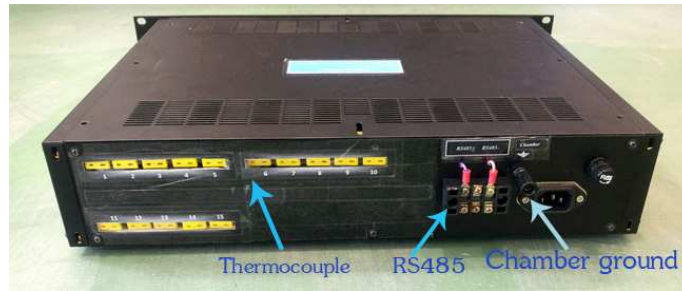
รูปที่ 8 ด้านหลังชุด Temperature Monitor
