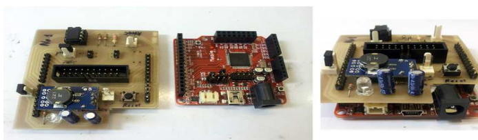
รูปที่ 5 บอร์ด Shield PCB และ คอนโทรลเลอร์ Maple
