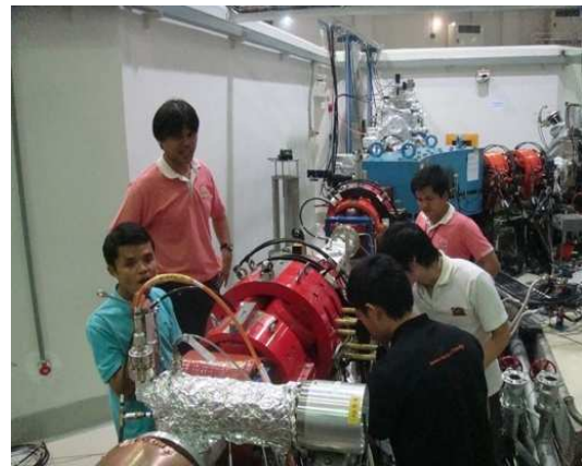
รูปที่ 15 การ Alignment แม่เหล็กสี่ขั้ว
