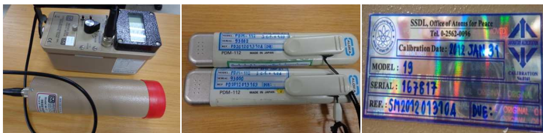
รูปที่ 4 แสดงเครื่องวัดรังสีที่ทำการสอบเทียบ
