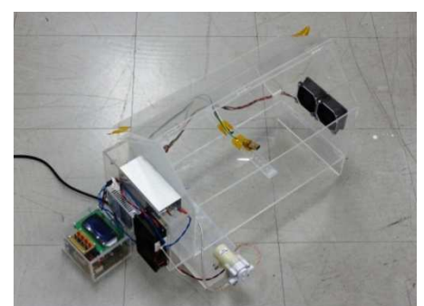
รูปที่ 3 ชุดทดสอบและควบคุมความชื้น
